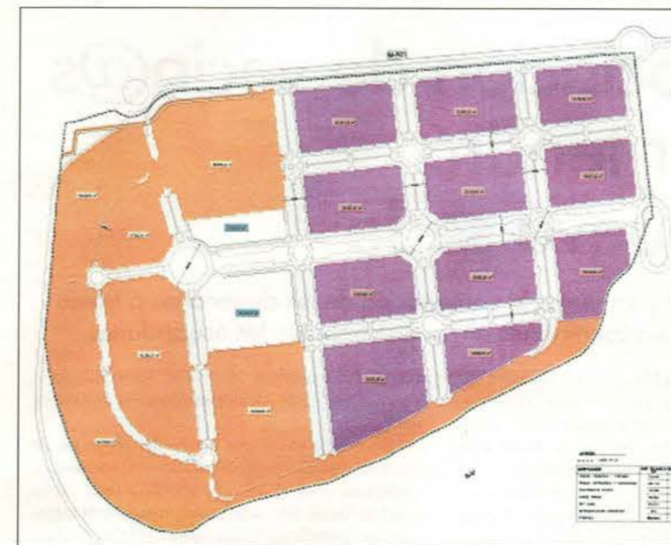
El Parque Tecnológico El Lucero tendrá una superficie superior a los 800.000 m2 y contará con diferentes usos: en color naranja los usos públicos y en violeta los privados
