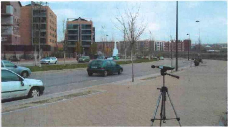
Observaciones: Medida realizada del ruido normal en la calle Oslo, en otro punto, con intensidad de tráfico elevada. Medida realizada con Sonómetro integrador modelo 2238 Mediator de la firma Brüel & Kjær.
