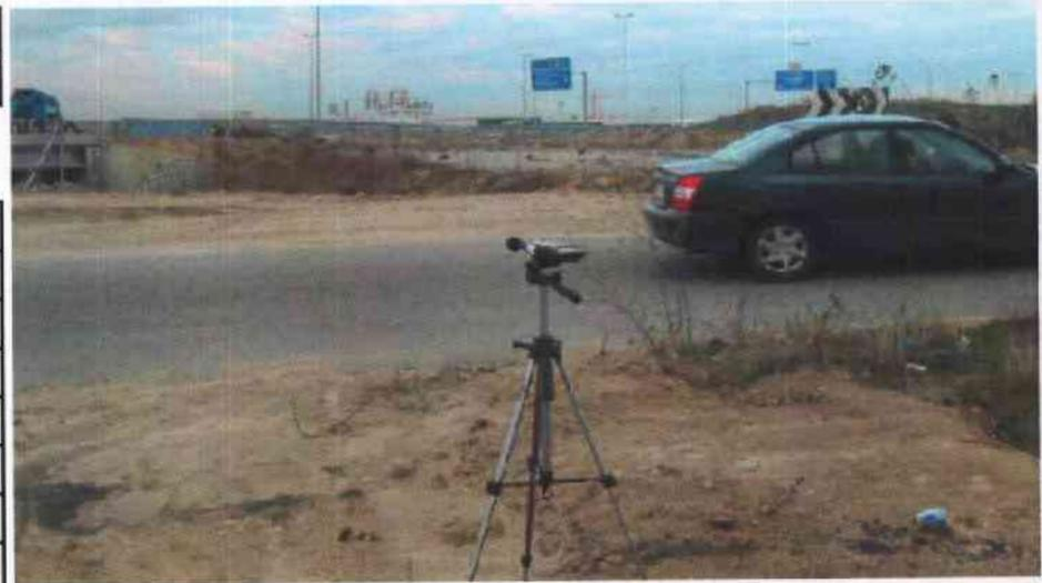
Observaciones: Medida realizada de la M-50 y M-506, en la salida de la M-506 hacia los centros comerciales. Se aprecia el ruido de una radial de las obras cercanas, y el paso de los coches que salen de la M-506. Medida realizada con Sonómetro integrador modelo 2238 Mediator de la firma Brüel & Kjær.
