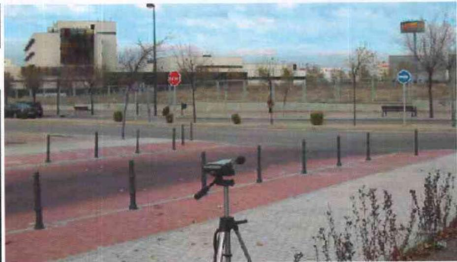
Observaciones: Medida realizada de la calle Oslo, con tráfico intenso. La marca corresponde al paso de un avión, procedente del cercano aeródromo de Cuatro Vientos. Medida realizada con Sonómetro integrador modelo 2238 Mediator de la firma Brüel & Kjær.
