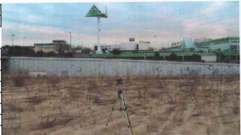
Observaciones: Medida realizada de la M-506, en el centro de la salida de la M-506 hacia los centros comerciales. Se aprecia el ruido de una radial de las obras cercanas. Medida realizada con Sonómetro integrador modelo 2238 Mediator de la firma Brüel & Kjær.
