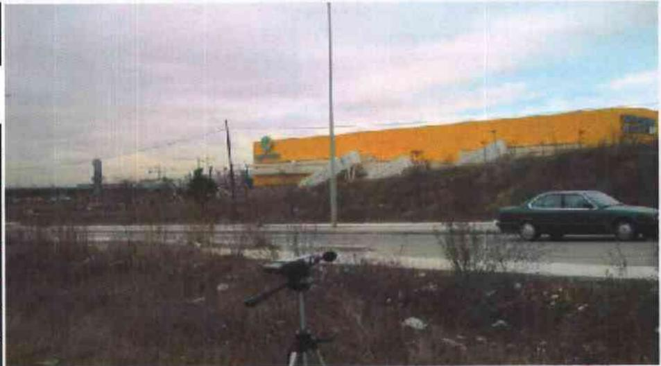
Observaciones: Medida realizada en la avenida de Móstoles a la altura de nuestro sector. Medida realizada con Sonómetro integrador modelo 2238 Mediator de la firma Brüel & Kjær.
