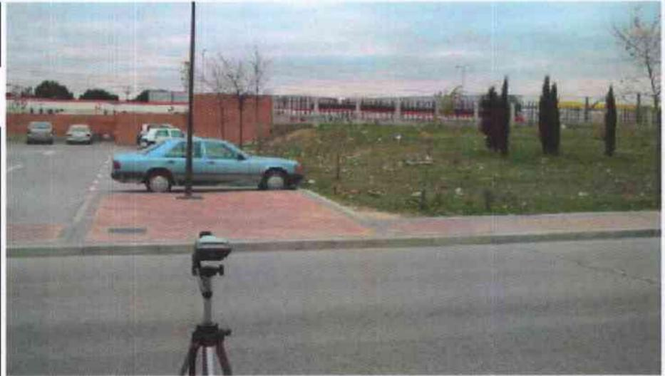
Observaciones: Medida realizada en la calle Berlín, enfrente de la estación de FFCC. Los marcas y los picos corresponden al paso de vehículos por delante del sonómetro. Medida realizada con Sonómetro integrador modelo 2238 Mediator de la firma Brüel & Kjær.
